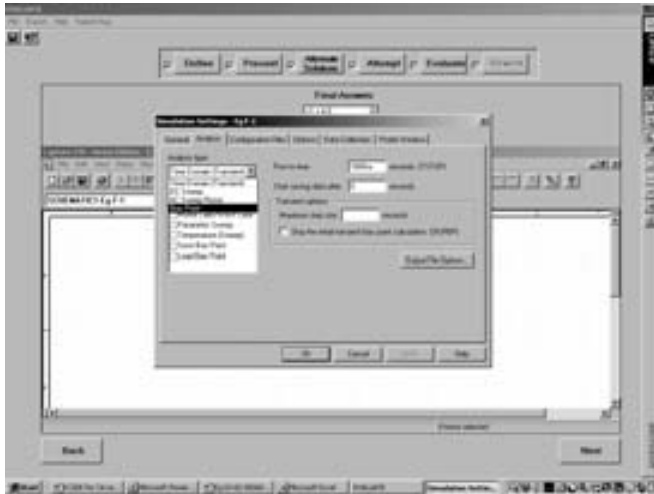
Figura F.13 Preparación del circuito para encontrar su solución con la ayuda de PSpice .
